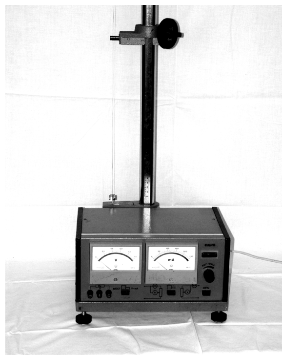
Рис. 9.1. Установка для измерения удельного сопротивления тонкого провода
